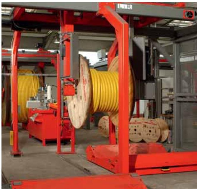
Отрезка с крупногабаритных барабанов
